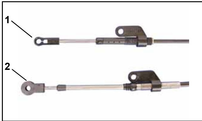
4. Throttle cable end 5. Shift cable end
