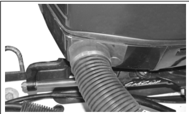
Flexible conduit installation
