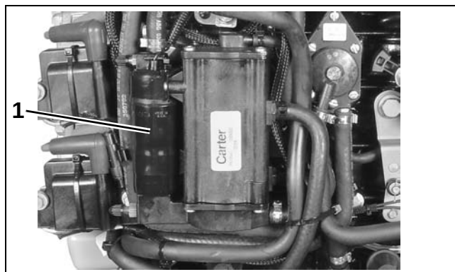
Vapor Separator Assembly
